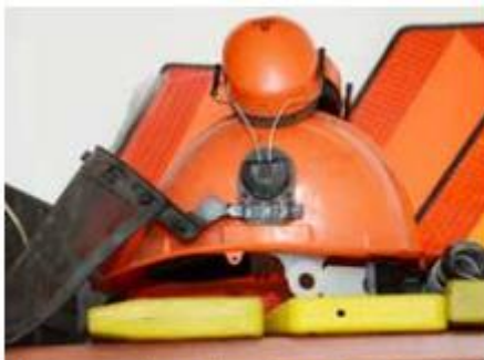
Kask z ochronnikami wzroku i słuchu chroni głowę i twarz przed uderzeniem drewnem i nadmiernym hałasem.
